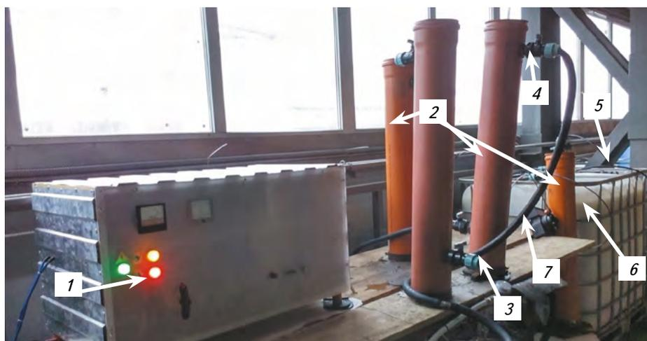
Рис. 2. Электротехнический комплекс получения наноразмерного гидроксида алюминия в производственных условиях «Юкрэиниан Шугар Компани» [9]: 1 – генератор разрядных импульсов; 2 – разрядные камеры; 3 и 4 – патрубки подачи воды и отвода коллоида алюминия; 5 – система аэрации; 6 – ёмкость с коллоидом алюминия; 7 – система подачи коллоида
